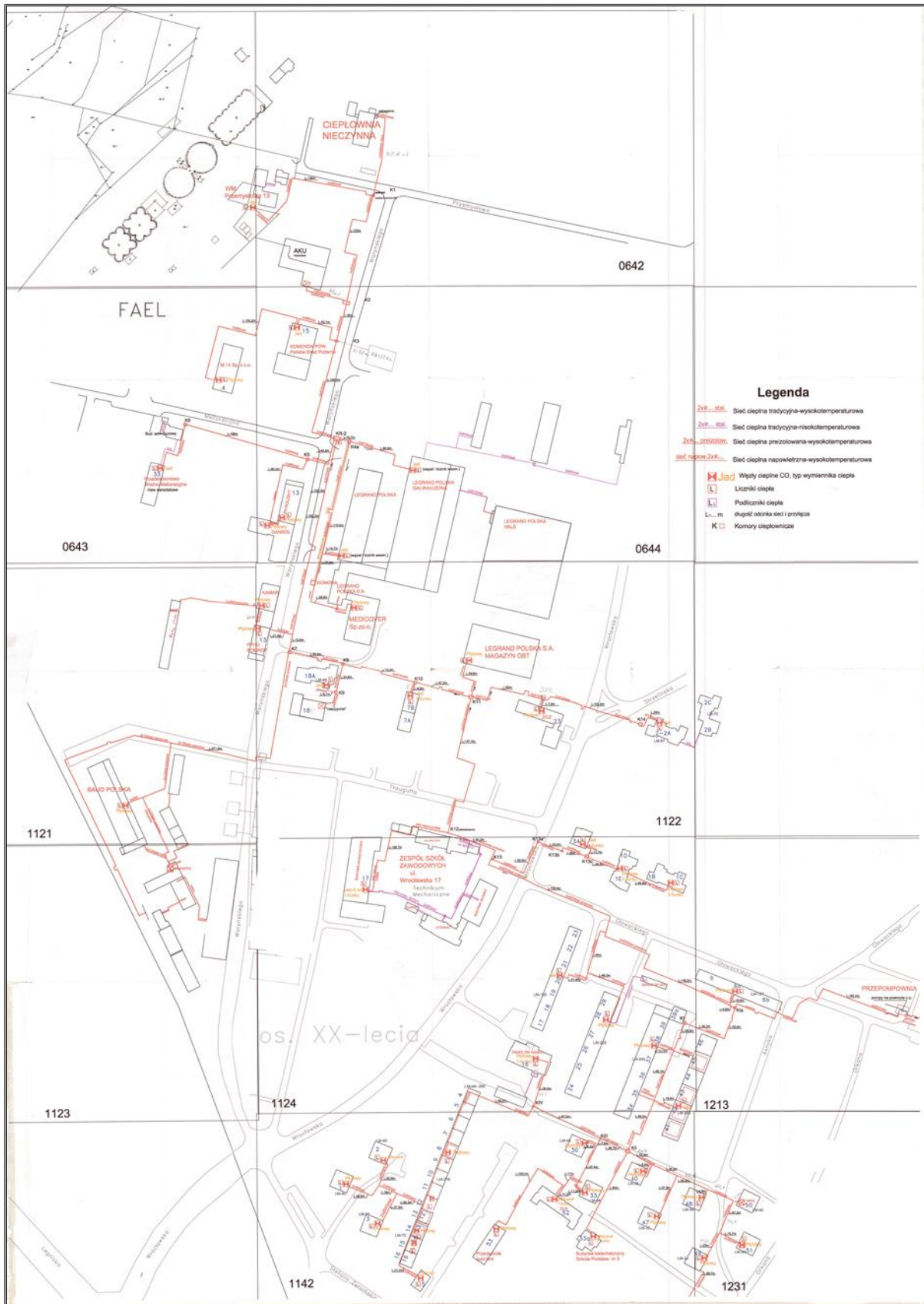
Rysunek 7. Schemat sieci ciepłowniczej na Osiedlu XX-lecia w Ząbkowicach Śląskich
