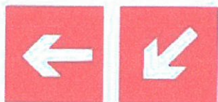
Kierunek do miejsca rozmieszczenia sprzętu pożarniczego
