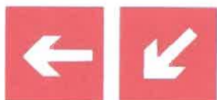
Kierunek do miejsca rozmieszczenia sprzętu pożarniczego
